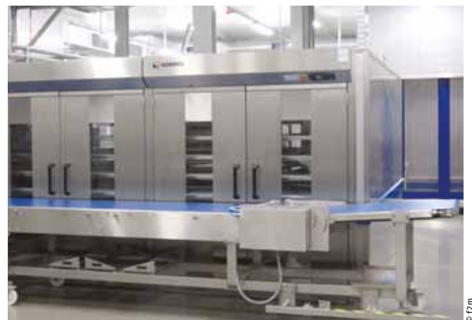
+++ Небольшие партии изделий отправляются в обход в проходные расстойные шкафы
