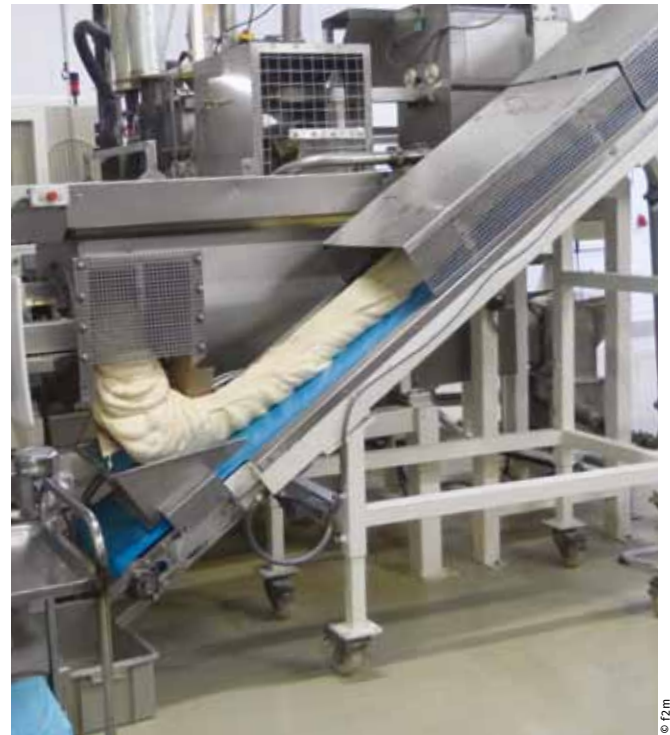
+++ Тестомес непрерывного действия производит тесто для линии Megaline II
