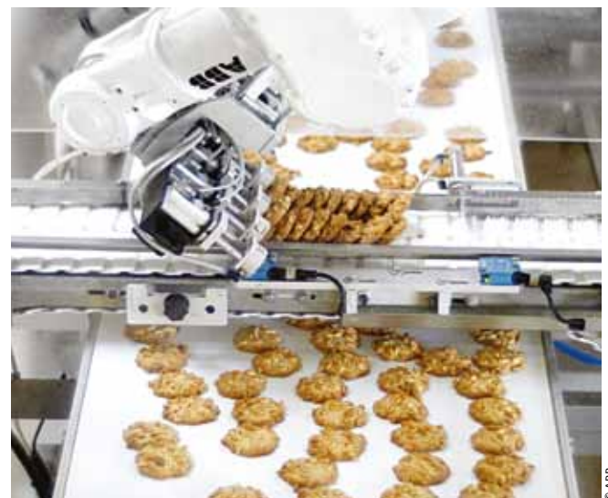
+++ Шестиосный робот IRB 140 фирмы ABB упаковывает на предприятии Interbanket 19 различных видов печенья; переналадка на другой продукт занимает от 5 до 10 минут
