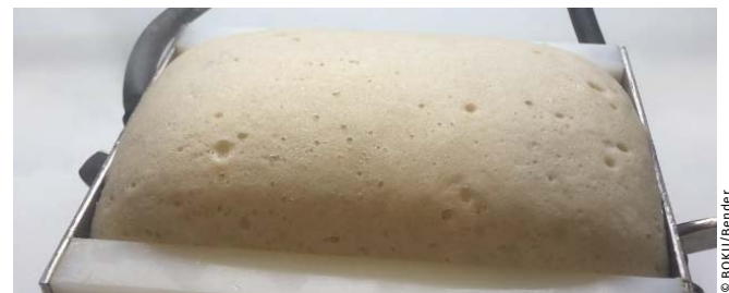
+++ Омический нагрев теста между двумя электродами в форме для омического нагрева
