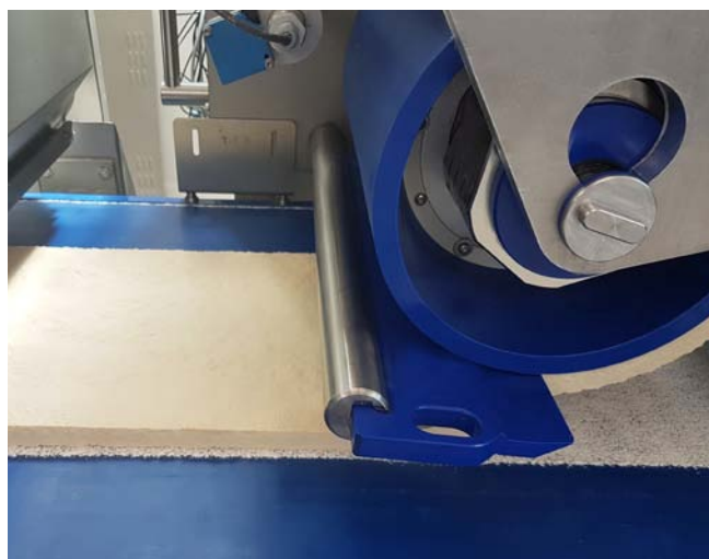
+++ Переработка теста для производства тортильи на оборудовании для производства тестовой ленты
