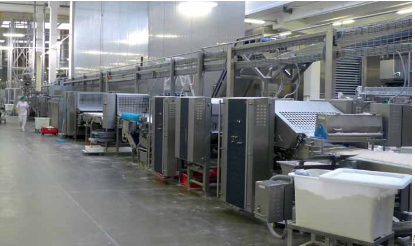
+++ На линии IMPRESSA Bread фирмы FRITSCH с системой бережной обработки производятся каратти на основе тестовой ленты
