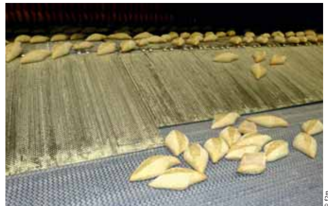
+++ Полуфабрикаты каратти на выходе печи FTP с газовым обогревом, состоящей из каменных плит
