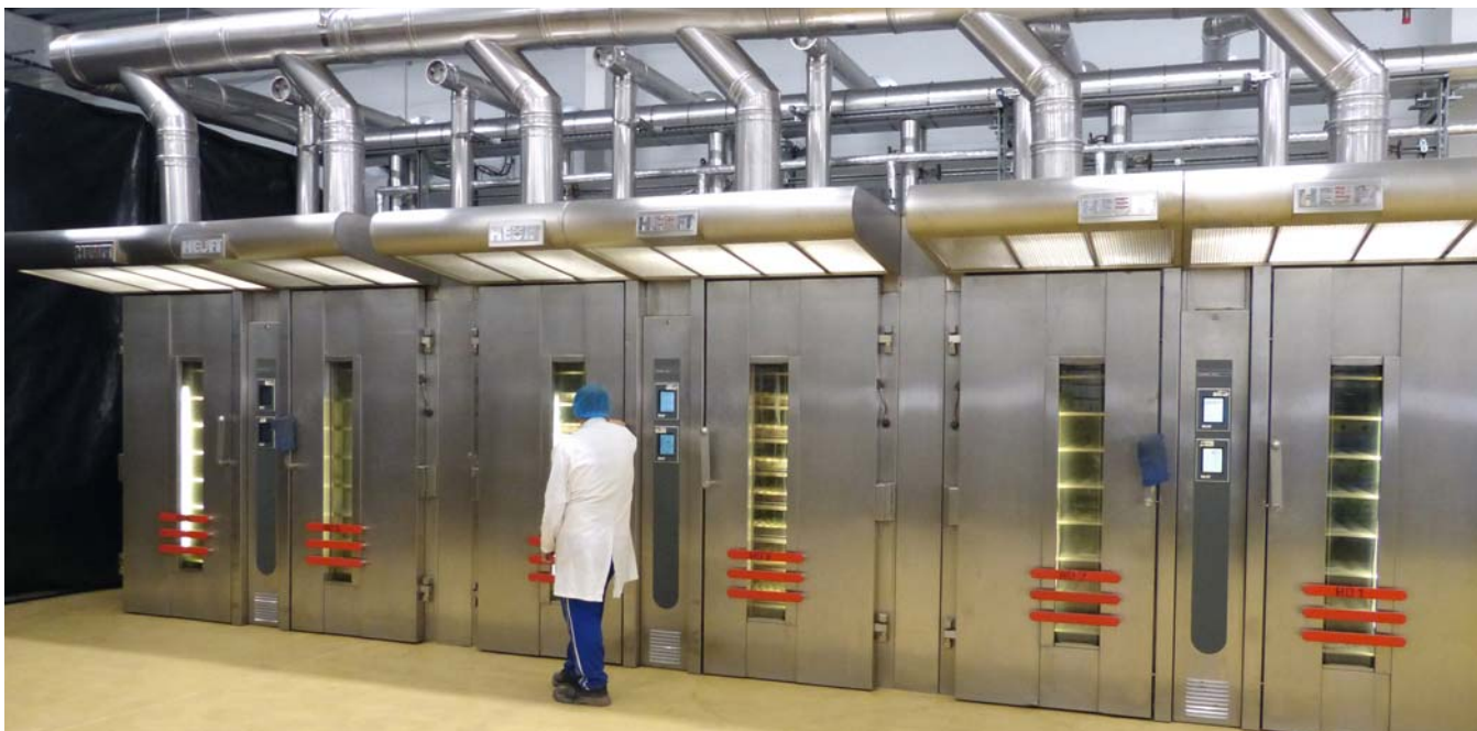
+++ Помимо тележечной печи, фирма Heuft поставила для нового предприятия многоярусную туннельную печь с масляным теплоносителем и каменными плитами
