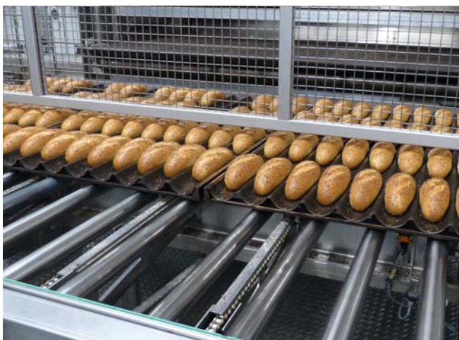
+++ Мелкоштучка на выходе из печи
