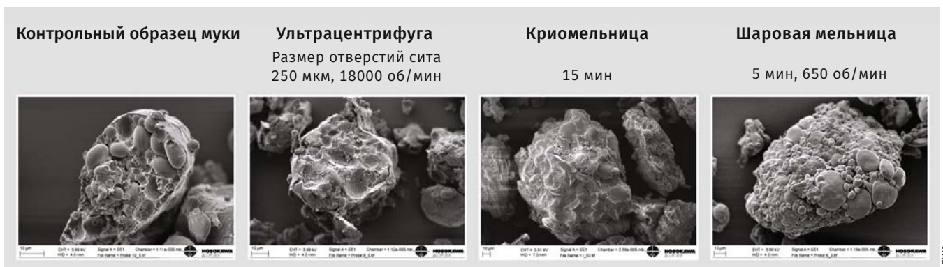
+++ рисунок 4: Снимки контрольных и модифицированных образцов муки, сделанные растровым электронным микроскопом
