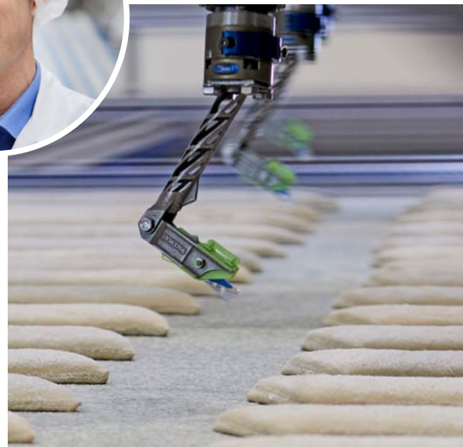
+++ Роботы делают надрезы на заготовках. Процесс полностью автоматизирован
